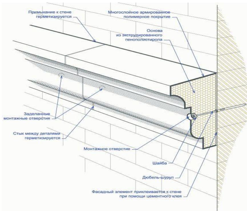
Прежде чем приступить к монтажу декоративного изделия, проверьте поверхность, на которую оно будет крепиться, убедитесь в ее прочности и чистоте, выровняйте и загрунтуйте впитывающим и связующим составом. Обеспечьте плотную, жесткую и надежную связь без щелей и зазоров. Это можно сделать с помощью клея, дюбелей, шпилек и различных закладных деталей (не зависимо от выбранного способа крепления, клей используется в обязательном порядке).
